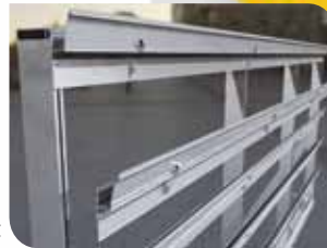
Volets permettant de remplacer rapidement les échantillons
