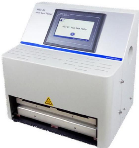
Der Heißsiegel Tester wird zur Messung der Heißsiegelfähigkeit von Oberflächen- oder Dichtungsschichten von Folien, Laminaten, Verbundwerkstoffen und Polymeren etc. verwendet. Wie gut sich das Material zum Verschweißen eignet wird quantitativ als Siegelfestigkeit in Abhängigkeit von den Siegelbedingungen wie Temperatur, Zeit und Druck bewertet.
