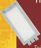
SL-3T<br>Einfach mit Rückenklammer<br>Teilenummer 19163900                             | Universalhalter für dünne Proben                                                                       | Textilien, Plastikfilm, Automobilinnenmaterialien                                 | 67 x 145 x 3              | 50 x 121                    | Ci3000+<br>Ci4000<br>Ci5000 | 20<br>68<br>111     |
